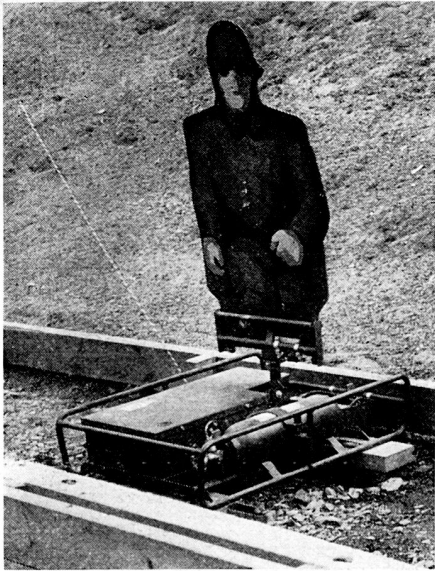
Bild 4. Die Klappscheiben sprechen nur auf direkte Treffer, nicht aber auf Querschläger an. Die Scheibe kann mittels Fernsteuerung wieder aufgeklappt werden.
