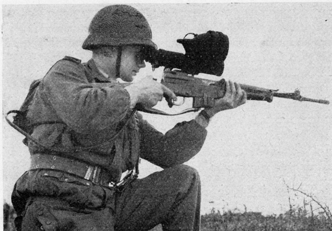
Auf das Gewehr angepaßter Infrarotprojektor mit Zielfernrohr.
