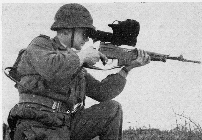
Auf das Gewehr angepaßter Infrarotprojektor mit Zielfernrohr.
