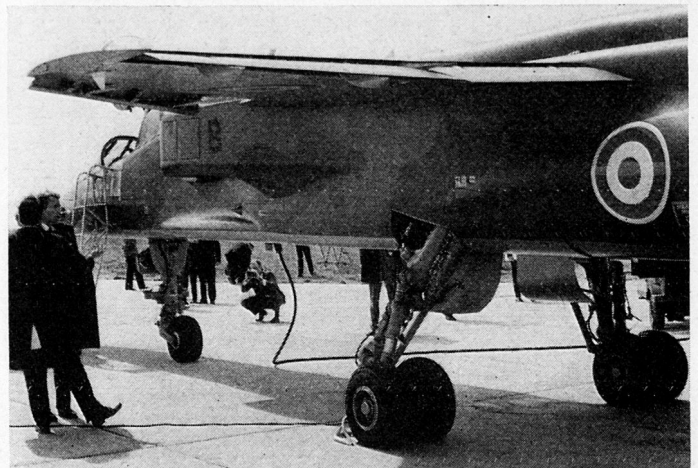
Bild 3. Der sehr schlanke Flügel des «Jaguar» mit seinen Hochauftriebs-hilfen. Gesteuert wird mittels Störklappen, verstellbarer Höhenflosse und Seitensteuers.
