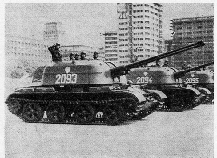
Bild 8. ZSU 57-2 (UdSSR). Veraltet; relativ schwer, kein Radar, jedoch große Schußweite und Treffsicherheit mit optischem Visier.
