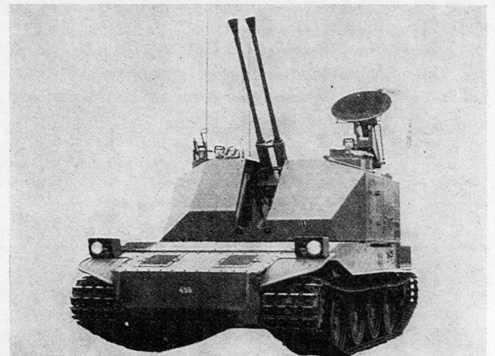
Bild 7. VEAk 40 x 62 (Schweden). 40-mm-Zwillingsgeschütz Bofors L70; Rundsuch-, Sektorsuch- und Entfernungsmessprogramm.
