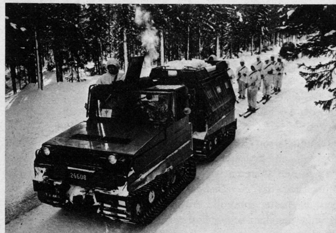
Bild 10. Der Raupentruktor mit seinem Anhänger, eine schwedische Spezialkonstruktion, bewährte sich so gut, daß er auch bei anderen Armeen Nordeuropas, wie in Finnland, zur Einführung kam.
