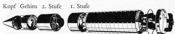
Bild 3. MSBS (mer-sol-balistique-stratégique) zweistufige Mittelstreckenrakete für Atom-U-Boote.
