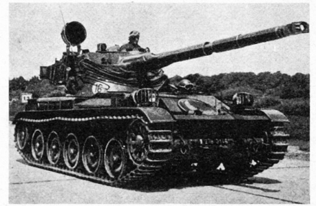
Bild 2. Jagdpanzer AMX 13, Kanone 90 mm.
