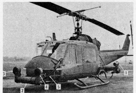
Bild 1. Bell «Iroquois» mit dem INFANT-System. (1) Xenon-Suchlichter, (2) Spezial-Bugdrehturm für INFANT, (3) Nachtsichtgerät, (4) direktes Bildverstärkungsvisier, (5) Faseroptikkabel.
