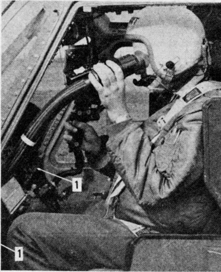
Bild 2. Das direkte Fernsichtsystem, kleine Monitore (1) in der Instrumententafel.
