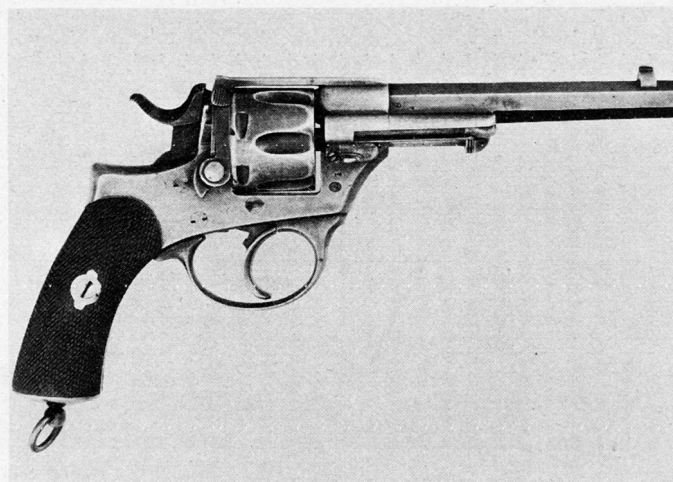
Bild 4. Eidgenössischer Ordonnanz-Revolver 1872 (modifiziert) CDS. Für die Schweizer Armee sind 904 Stück hergestellt worden. Das gleiche Modell, jedoch für Zentralzündung eingerichtet, fand auch in der italienischen Armee Eingang.
