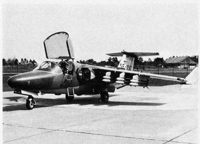
Bild 1. Saab 105 XT mit zwölf 13,5-cm-Raketen (ungelenkt), Zuladung 504 kg, Startgewicht 5,1 t, Startrollstrecke 475 m, Lo-Lo-Lo 315 km, Hi-Lo-Hi 830 km.
