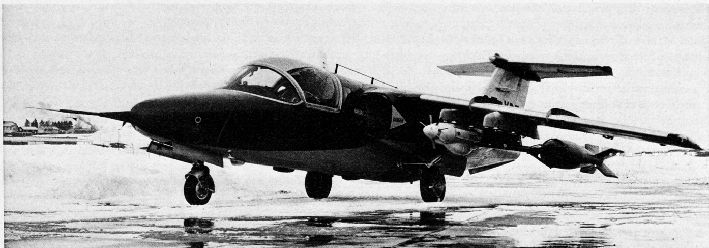
Bild 2. Saab 105 XT mit Zielschleppausrüstung, Zuladung 252 kg, Start-gewicht 5,2 t, Startrollstrecke 500 m. Mögliche Einsatzflugzeit in 10 km Flughöhe mit 800 km/h Geschwindigkeit und 100 km vom Startplatz entfernt: 75 min mit 20 % Brennstoffreserve.
