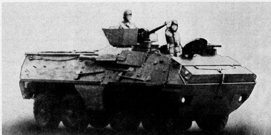
Bild 1. OT 64 mit 12,7-mm-Maschinengewehr im Drehturm.
