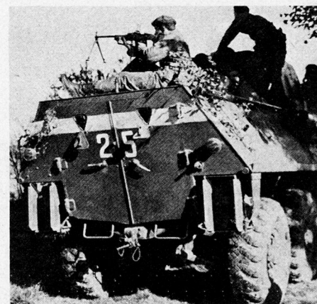
Bild 3. OT 64, Heckansicht. Man beachte die Schrauben hinter den Hinterrädern, die Schraubenfedern der Querlenker-aufhängung, die Schießöffnungen und die hohen Klappen über dem Besatzungsraum.
