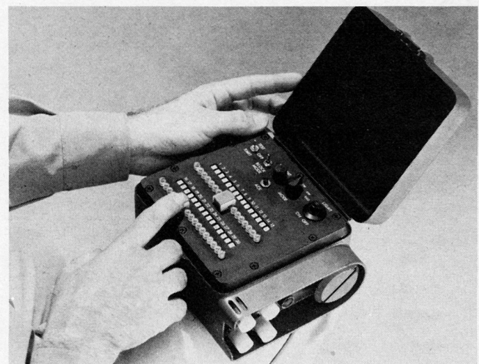
Bild 8. Das Eingabegerät des Schießkommandanten.
