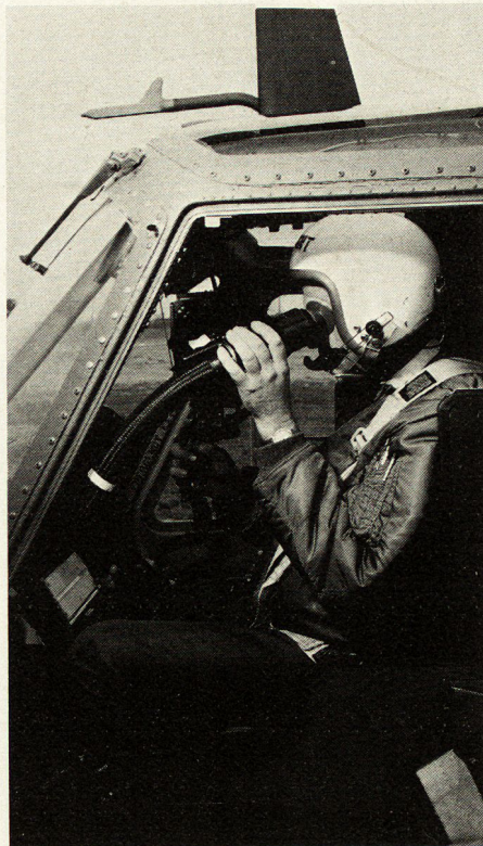
Bild 1. Intensivbildbeobachtung durch das Fiber-Optik-Kabel.
