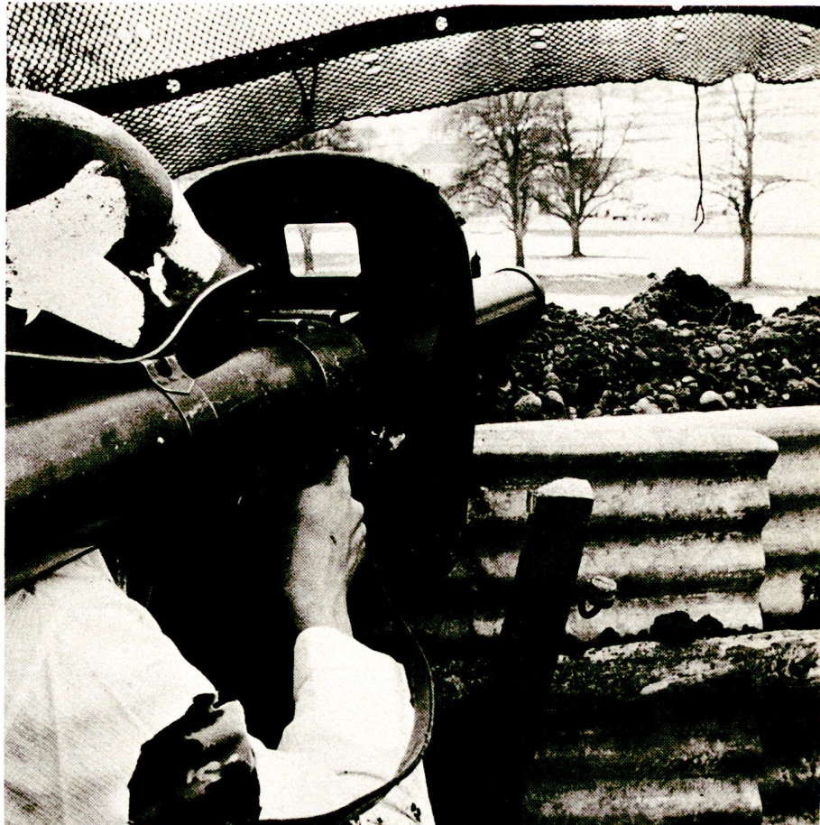
Mit dem Raketenrohr können Panzer bis auf eine Distanz von 200 bis 300 m bekämpft werden. Eine neue Munition soll die Einsatzdistanz erhöhen. (Keystone)
