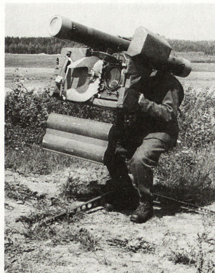
Bild 1. Die RBS 70-Feuereinheit von AB Bofors besteht aus einer Lenkwaffe im Behälter/Abschußrohr, einem Lenkgerät mit Leitstrahl-sender und einem Stativ, wodurch die ganze Anordnung um 360° drehbar ist. Am Stativ befindet sich auch ein Sitz für den Schützen. Die IFF-Einheit wird vom SATT entwickelt und ist unter dem Lenkgerät befestigt. Ein Zieldatenempfänger wird ebenfalls bei der Feuereinheit placiert. Ein Tonsignal im Empfänger ermöglicht dem Schützen, die Richtung zum Ziel, innerhalb von 20 km Abstand einzunehmen.
