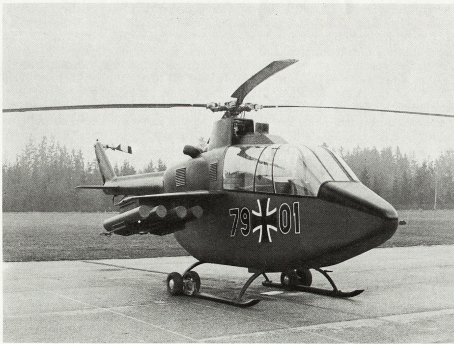
Leichter Panzerabwehrhubschrauber Bo 115 der Firma Messerschmitt-Bölkow-Blohm. Abfluggewicht etwa 2,5 t, Bewaffnung bis zu 8 Panzerabwehrkraketen. Zwei Turbinen.
