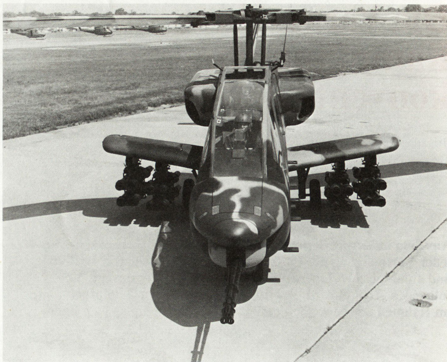
Advanced Attack Helicopter (AAH) YAH63 der Firma Bell (USA). Abfluggewicht 7 bis 8 t, zwei Turbinen zu 1500 PS, Bewaffnung bis zu 16 Panzerabwehrlenkkraketen beziehungsweise Mischbewaffnung aus gelenkten und un gelenkten Raketen sowie Maschinenkanonen. Forward Looking Infrared (FLIR) für Einsatz bei Tag und Nacht.
