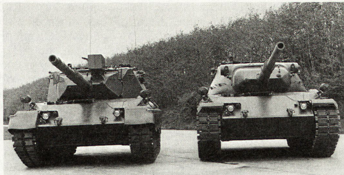
Bild 5. Links der «Leopard A3», rechts ein noch nicht nachgerüsteter, jedoch mit neuen Raupen versehener «Leopard A1».
