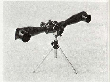
ewe Bild 2. Scherenfernrohr gespreizt, für beste stereoskopische Tiefenwirkung.
