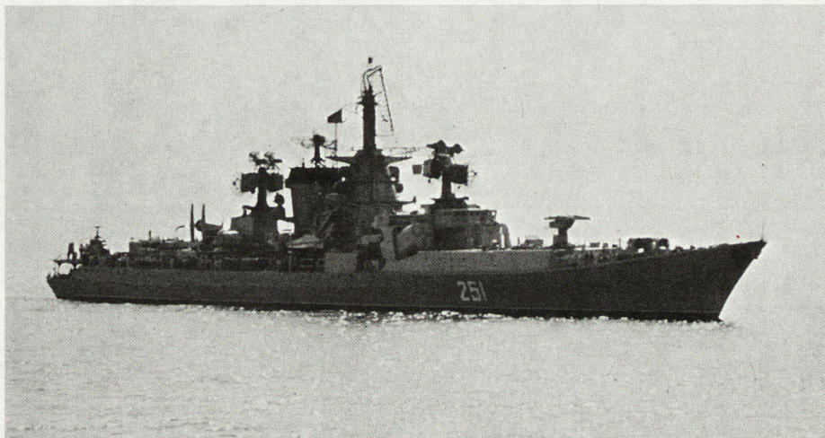
Bild 7. «Kresta-II»-Raketenkreuzer. 7500 t, 156 m, 33 Knoten. 2 Vierfachwerfer für SS-N-10-Schiff/Schiff-Flugkörper, 2 Werfer für «Goblet»-Fliegerabwehrraketen SA-N-3, 4 × 57-mm-Flabkanonen, 10 Torpedorohre, U-Boot-Abwehrwaffen, Helikopterlandeplatz und -hangar. Seit 1970 wurden 7 Schiffe in Dienst gestellt.
