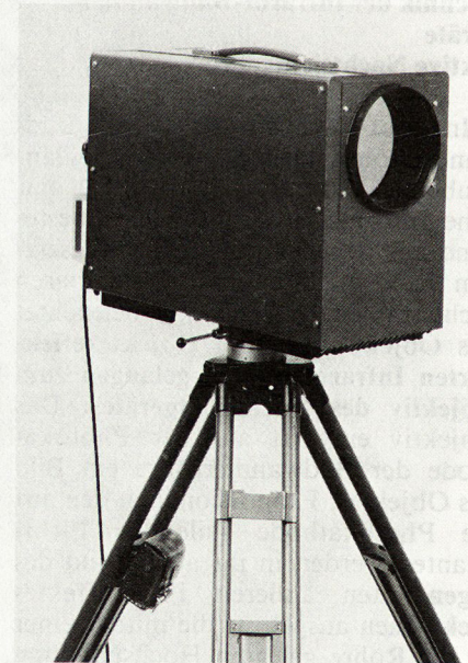
Bild 4. Wärmebildgerät (WBG 2) mit einer Temperaturauflösung von 0,1° K.
