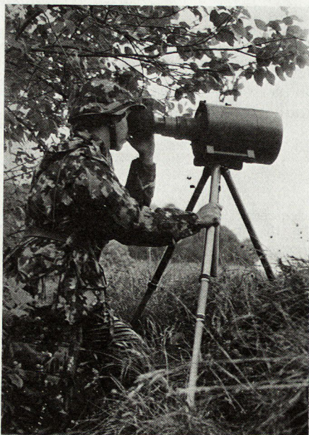
Bild 2. Restlicht aus der Atmosphäre ge- nützt diesem Beobachtungsgerät (RDS 400/200) zur Szenenbeleuchtung.
