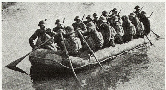
Bild rechts oben: Schlauchboot M6, bietet Platz für maximal 15 Mann. Gewicht des Bootes 170 kg, Länge 5,6 m, Breite 1,95 m.
