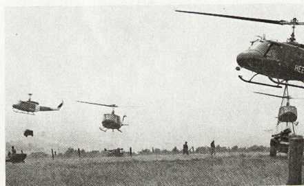
Bilder 6-12. Außenlasten an Transporthubschraubern (Waffen, Gerät, Fahrzeuge, Versorgungsgüter)
