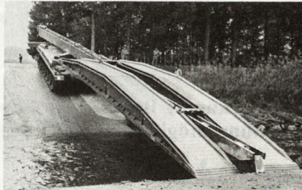
Bild 4. Ausfahren der Brücke mittels Schiebewagen
