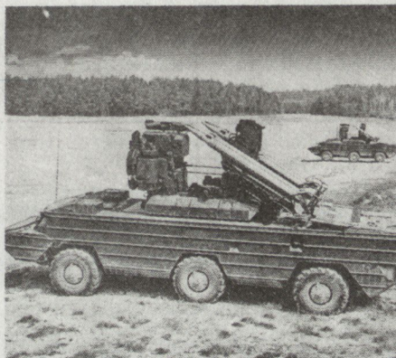
Bild 7. SA-8 Gecko, das jüngste Mitglied des Luftabwehr-Raketensystems, gegen Flugziele in niedriger bis mittlerer Höhe.
