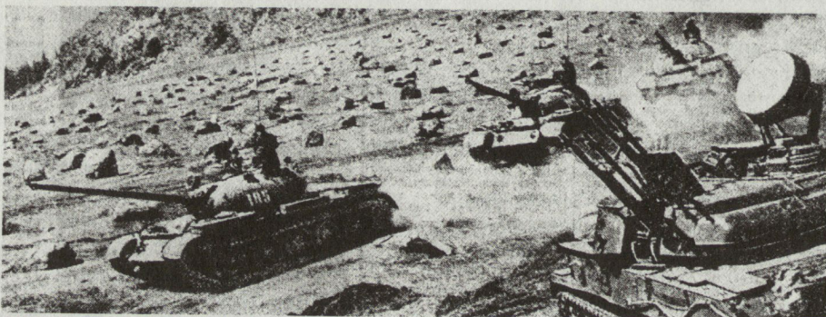
Bild 10. Eine Panzereinheit, ausgerüstet mit Panzern T-55, beim Marsch im Gebirge. Die Fliegerabwehr übernehmen ZSU-23-4.
