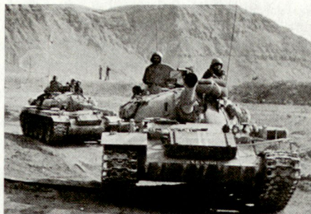
Bild 5. Israelischer Beutepanzer T-55, der auf 105-mm-BK umgerüstet wurde.
