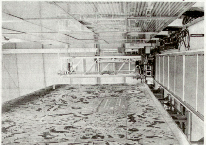
Bild 6. Zieldarstellungs-System von Redifon, bestimmt für Verwendung mit Flugsimulatoren. Naturgetreue Darstellung eines Flugplatzes.
