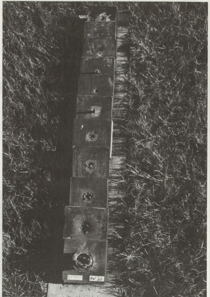
Bild 3. Ergebnis der Panzerdurchschlagsleistung: 90 cm Panzerstahl durchschlagen.
