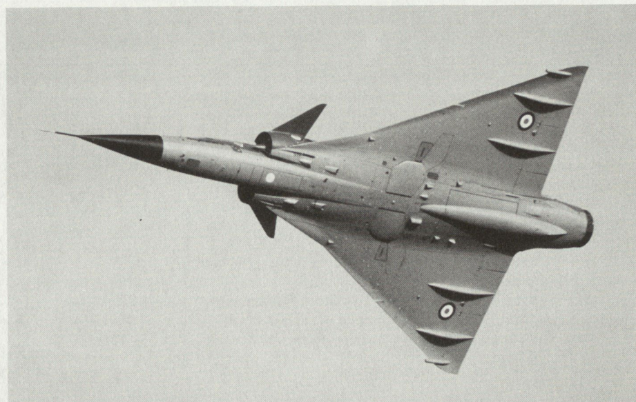
Untenansicht der Mirage 3NG. Deutlich sichtbar sind die «Canards» und die vorgezogenen Flügelwurzeln.
