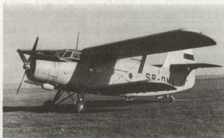
Während der Rumpf der AN-2 in Ganzmetallbauweise gefertigt ist, besitzen die Tragflächen und das Seitenleitwerk eine Tuchbespannung. Als Antrieb dient ein luftgekühlter 9-Zylinder-Sternmotor Shvetsov ASh-61 IR von 1000 PS. Dank dem kleinen Eigengewicht und einer genialen Doppelspaltklappenanordnung verfügt die AN-2 über STOL-Eigenschaften.
