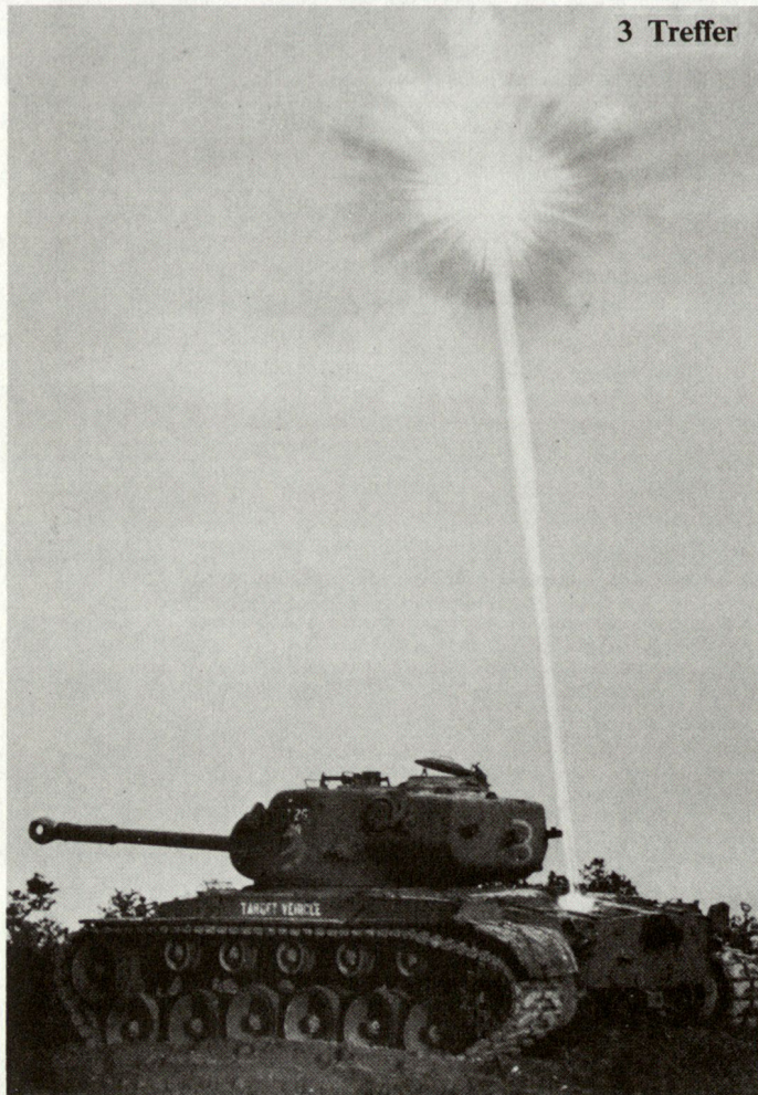
Zirka 20 m über dem Ziel bildet sich durch Explosion des Geschosses ein Projektil, welches den Panzer mit hoher Geschwindigkeit trifft.
