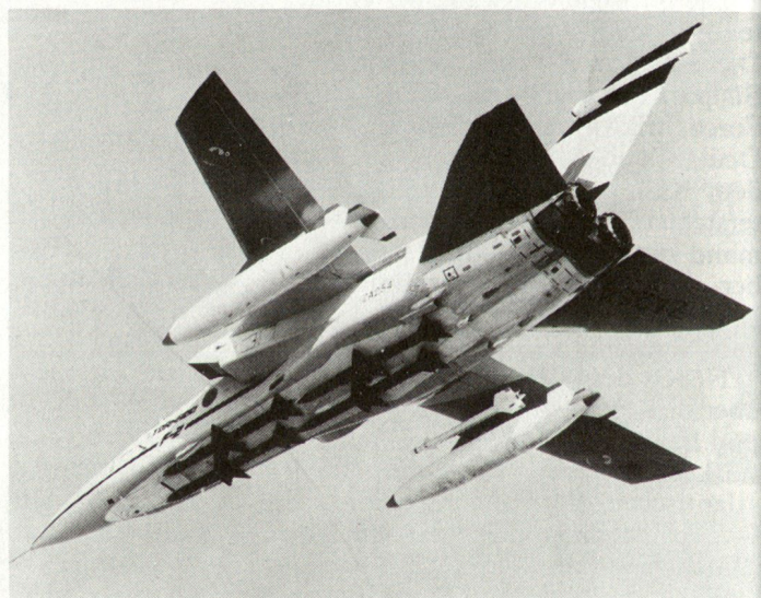
Bild 5. Typische Zuladung einer Tornado F2. Sie besteht aus 4 Sky-Flash- und 2 Sidewinder-Luft-Luft-Lenk Waffen sowie 2 Zusatztanks.
