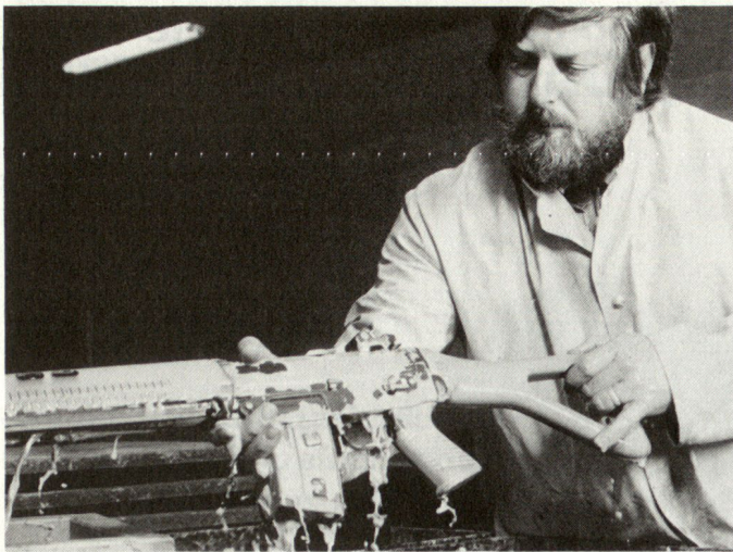
Erprobung des neuen Sturmgewehrs. Genormte Tests, unter anderem mit Sand und Schlammhädern, führen zu jederzeit reproduzierbaren und objektiven Ergebnissen. Nach jedem Versuch wird die Funktionsweise der Waffe bei Einzel- oder Seriefire überprüf.
