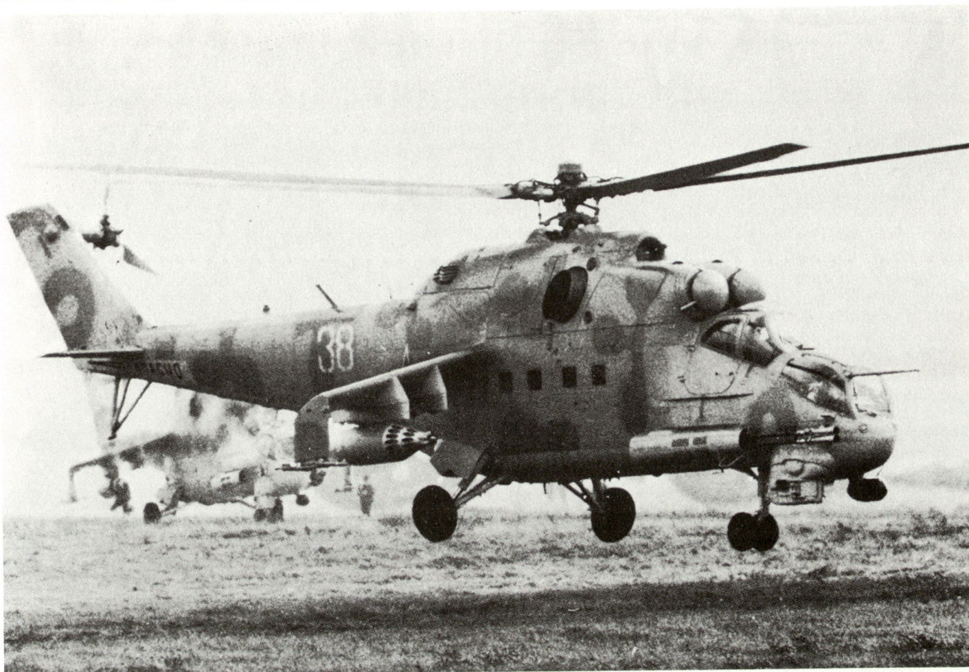
Mi-24 HIND/E mit Zweifachträger für AT-6 Spiral, Raketenbehälter UB-32 und neu rechts am Vorderrumpf angeordneter Behälter mit einer Zwillingen-Maschinenkanone 23 mm.
