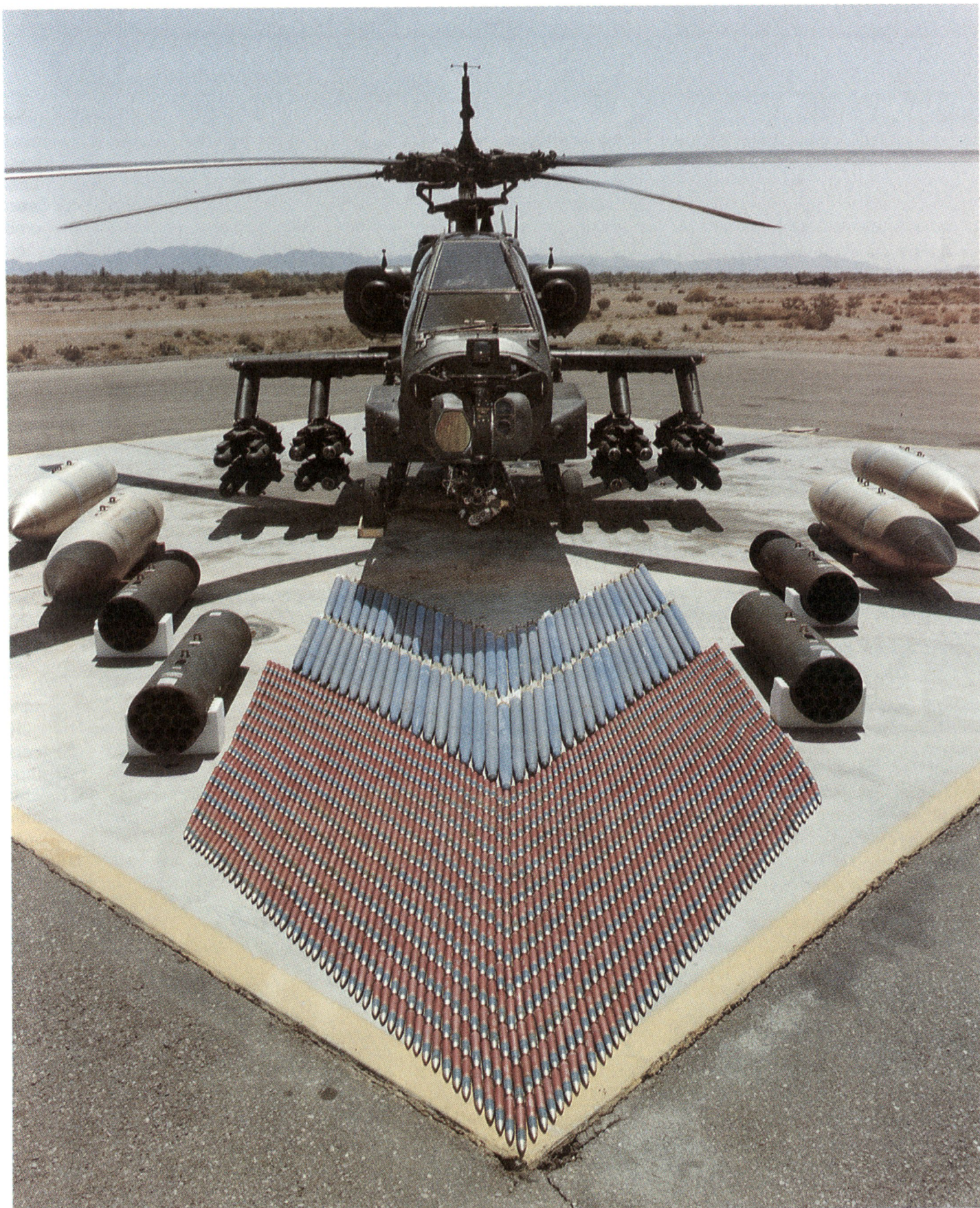
AH – 64 A Apache von Hughes USA. Bewaffnung: 16 Hellfire-Lenk Waffen (unter den Flügeln), 76 2.75-inch-Raketen (blau), 1200 Schuss 30-mm-Kanonen-Mun (rot). Ziel-Such- und Zuweisungs-Gerät, kombiniert mit Feuerleitgerät (Tag+ Nacht) im Bug des Heli.
