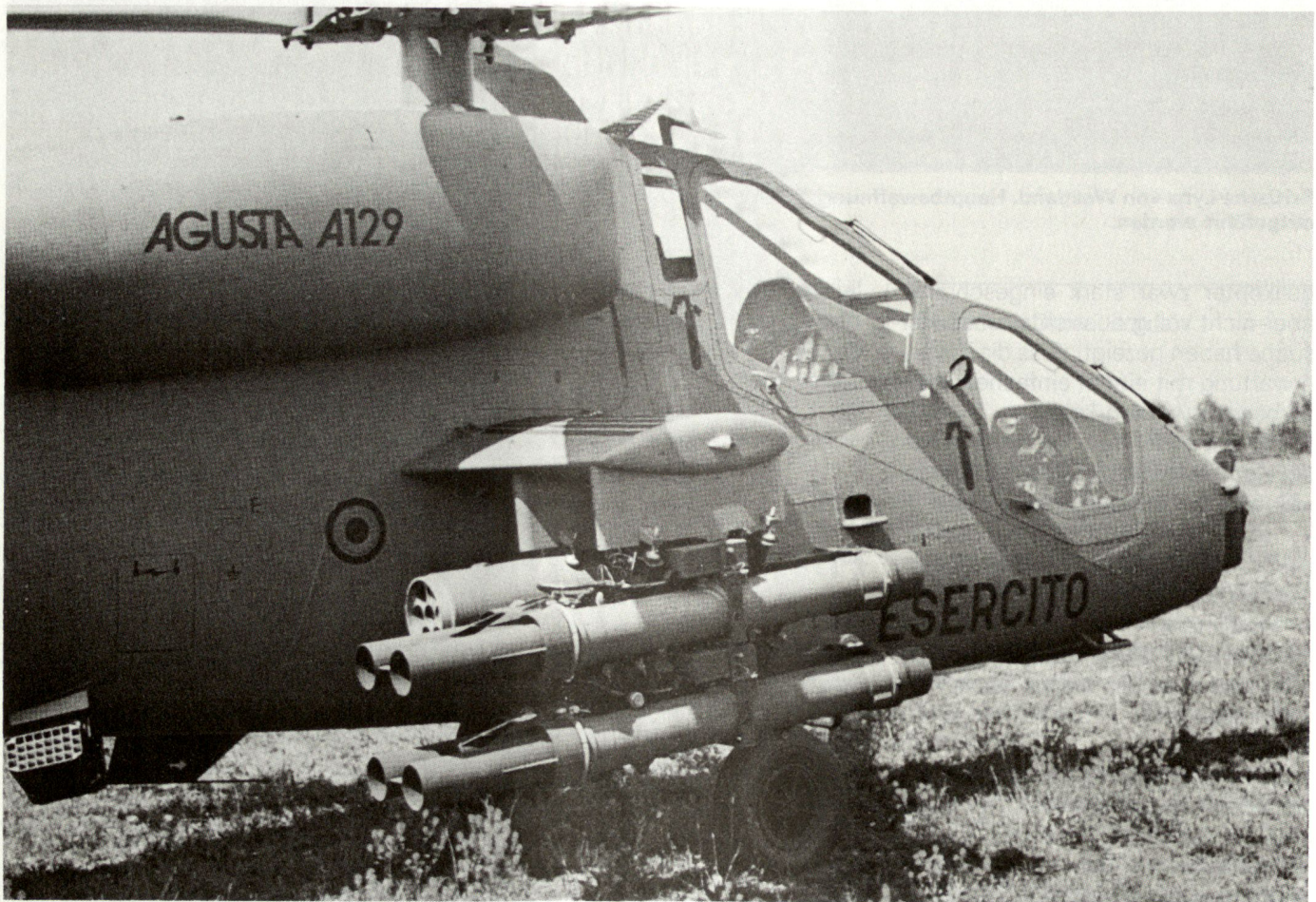
Die italienische Agusta A 129 Mongoose von Agusta-Milano. Bewaffnung: 8 TO7W Lenkwaffen, dazu alternativ Raketen und / oder Mg verschiedener Kaliber.
