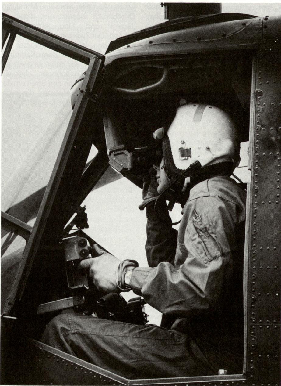
APX M 397 Visiergerät für Milan Panzerabwehrlenkwaffe (Lynx).
