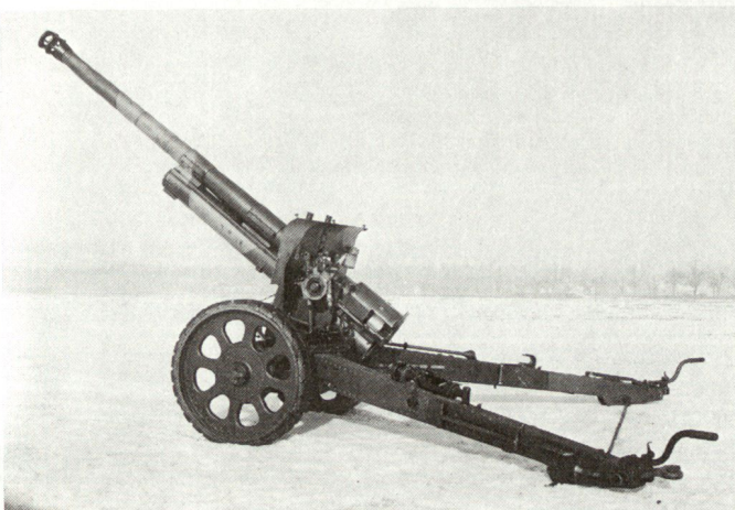
Die 10,5 cm Schwere Kanone in ihrer ursprünglichen Ausführung mit Vollgummireifen.
