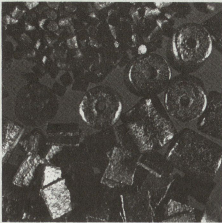
Beispiele aus der vielfältigen Produktpalette: kurzgeschnittene Nitrocellulose-Treibladungspulver.
