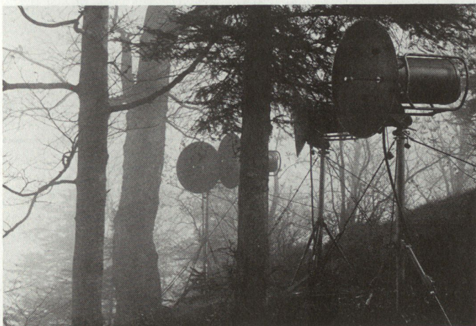
Bild 5. Die Richtstrahlstation R-902 für Digitalbetrieb umgebaut als Zubringer Knoten-Teilnehmerebene für gleichzeitig 15 Kanäle. Hersteller BBC, Baden.
