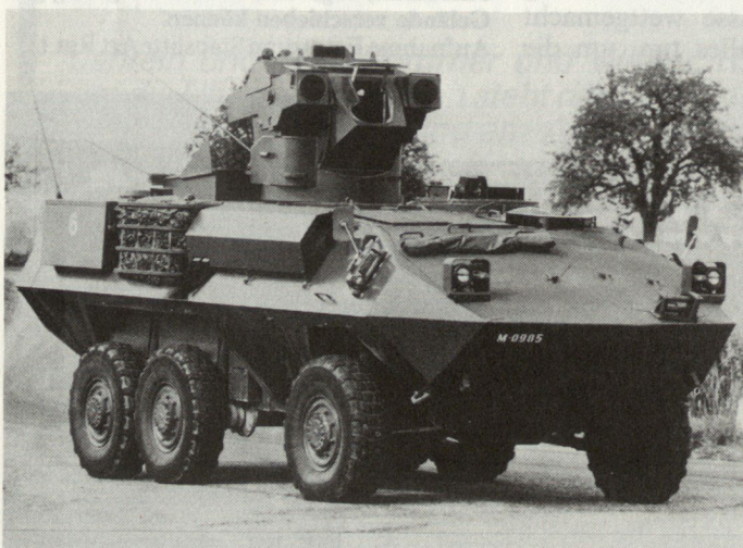
Bild 1. Panzerjäger. Fahrzeug PIRANHA 6×6, Lenkwaffe TOW-2
