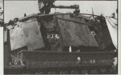
Bild 2b. Das Vorbild, die Blazer-Reaktivpanzerung an israelischen Kampfpanzern. Rechts der unbeschädigte Panzerturm nach einem Hohlladungsvolltreffer (IMI)
