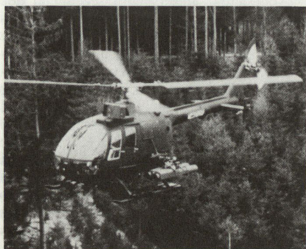
Schwedische Version des Panzerabwehr-Helikopters BO-105 CB, bewaffnet mit 4 PAL-Lenk Waffen TOW anlässlich von Truppenerprobungen.
