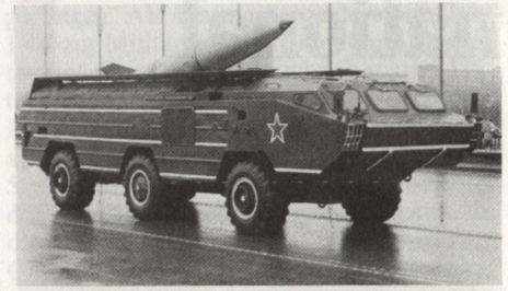
Taktisches Lenkwaffensystem SS-21 SCA-RAB auf dreiachsigen Radfahrzeug ZIL-5937. Zu jedem Abschussfahrzeug gehören ein bis zwei Nachladefahrzeuge mit je 2 Lenkwaffen.
