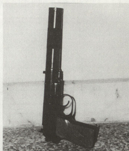
Abb. 5. Pistole PM Makarov ausgerüstet mit Schalldämpfer
