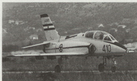
Bild 2: SOKO SUPER GALEB. Der G-4 Jettrainer könnte im Ernstfalle auch Erdkampfeinsätze ausführen. Dabei ist an vier Waffenkonsolen genügend Platz vorhanden, um eine Zuladung von insgesamt 1200 kg in das Zielgebiet zu bringen. Interavia-Bildarchiv.
