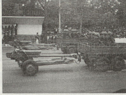
Bild 6: Kanonenhaubitze D-30, 122 mm. Max. Schussweite 15,3 km.
