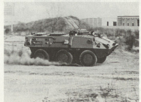
Bild 5: Radpanzer PANDUR 6×6 der Firma Steyr-Daimler-Puch AG. Dieser Panzer ist ebenfalls für den Export bestimmt, aber zurzeit beim Bundesheer nicht eingeführt. (Bild: Österr. Vert.-Min.)
