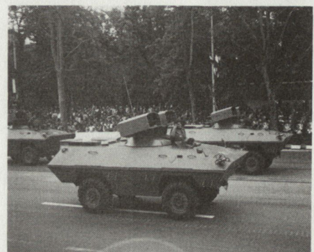
Bild 3: Raketen-Jagdpanzer BOV – 1 mit 2 x 3 PAL AT – 3 SAGGER. Reichweite 500 – 3000 m, Durchschlag 400 mm.
