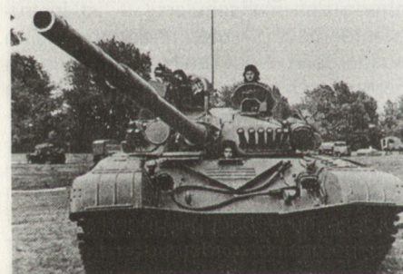
Bild 5b: Kampfpanzer M-84. Jugoslawischer Nachbau des sowjetischen T-72, ausgerüstet mit jugoslawischer FH-Anlage.
