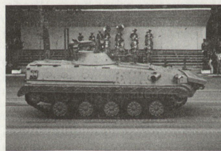
Bild 8: Kampfschützenpanzer M-80-A. Eigenentwicklung. 20 mm Sf Kan, 2 PAL AT-3, 1 Mg 7,62 mm. Bildnachweis für alle Bilder: ASMZ Archiv.
