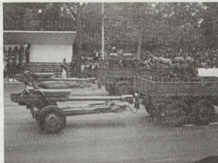
Bild 6: Kanonenhautitze D-30, 122 mm. Max. Schussweite 15,3 km.
