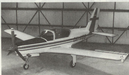
Bild 1: REDIGO L-90 Turbotrainer der Valmet Aircraft Division. Das Flugzeug ist voll kunstflugtauglich und auch für anspruchsvollere Ausbildungsstufen verwendbar. (Bild: Valmet Aircraft Division Halli)
