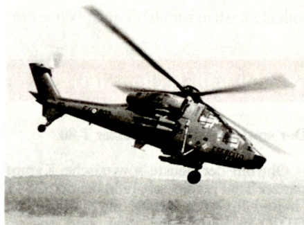
Seit letztem Oktober steht der PAH A-129 MANGUSTA im Dienst. Er verfügt über eine Bewaffnung von 8 PAL TOW-2 und eine Abschussvorrichtung für un gelenkte Raketen. Diese Panzerabwehrhelikopter sollen im Einsatz von Beobachtungshelikoptern des Typs A-109 begleitet werden. Bt (Aus 8/88)
