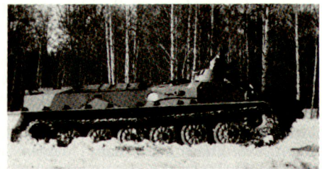
Abb. 1: Ketten-Schützenpanzer MT-LBV (Kettenbreite 565 mm anstatt 350 mm der Normalversion).
